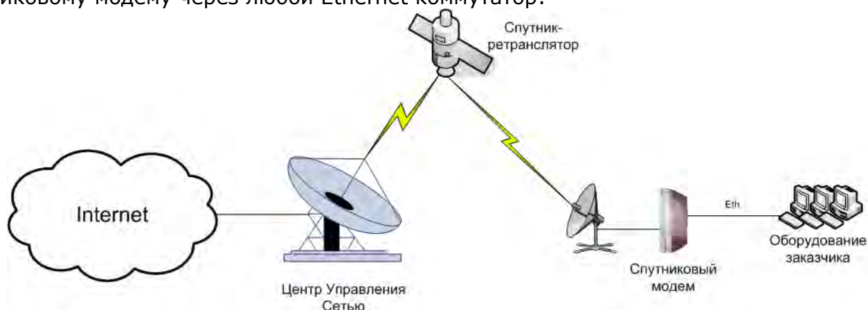
Рисунок 1. Общая схема подключения к спутниковому модему.
